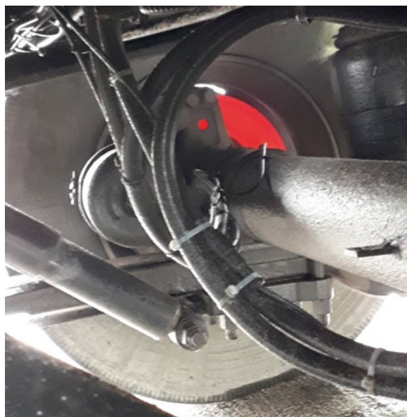
Glühende Bremsscheibe an einem Sattelanhänger
