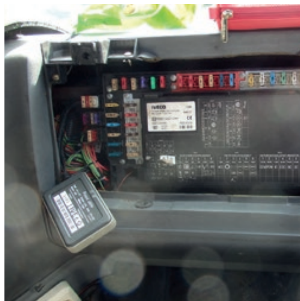
Bild links: Ein im Sicherungskasten verbauter AdBlue-Emulator Bild rechts: Detailfoto eines AdBlue-Emulators Bild unten: Manipulation an der Druckluftzufuhr für die AdBlue-Anlage
