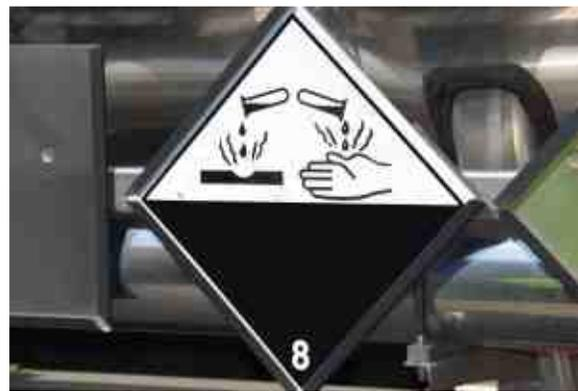
Kennzeichnung eines Gefahrguttransportes
