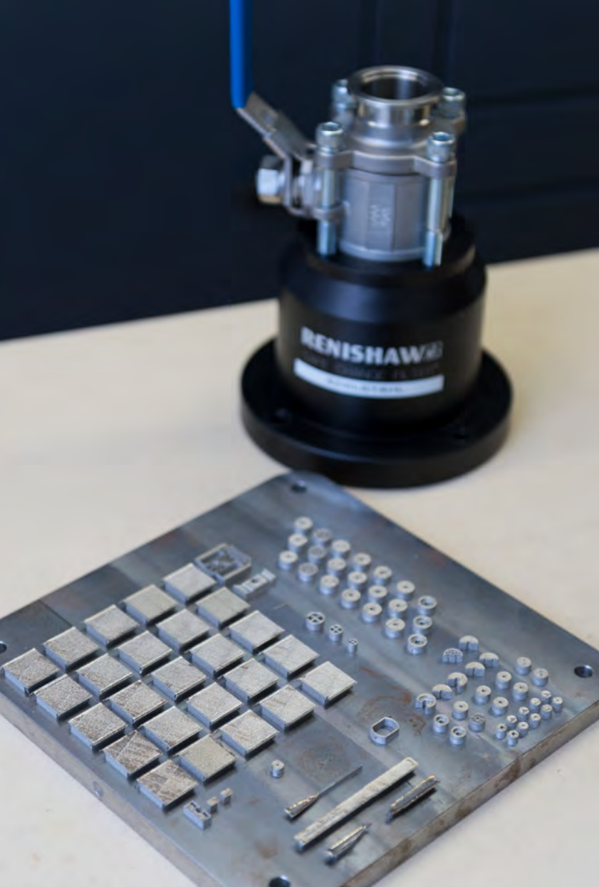
Bauplattform mit gedruckten Probekörpern aus Edelstahl
