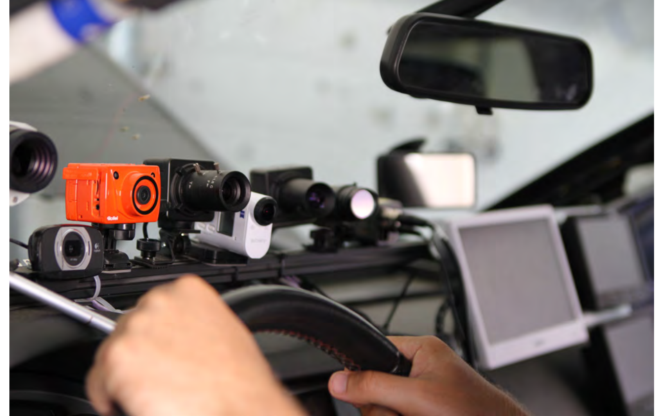
Technik zur Erfassung psychophysiologischer Daten im Versuchsfahrzeug, Thermographie Kamera, Webcamera und 4 K Kamera sowie Mult
