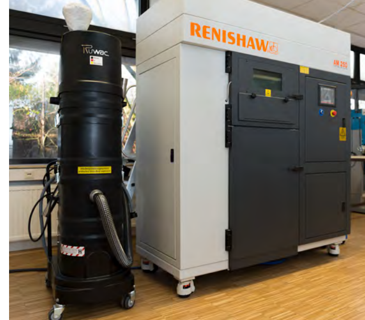
Anlagensystem Renishaw AM 250 für den 3D-Druck metallischer Bauteile am iWFT
