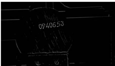
Abb. 6: Ergebnis der Bildvorverarbeitung für das Prägestück „0940653“
