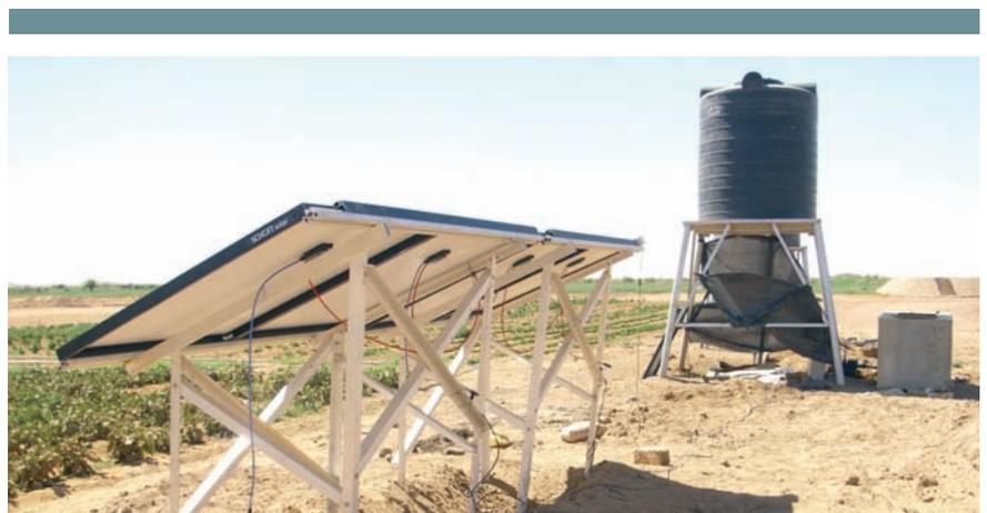
Abb. 4: Versuchsstation in der Wüste. Solarbetriebenes Niederdruckbewässerungssystem, Solar-Module und Pumpe-Wasserspeicher
