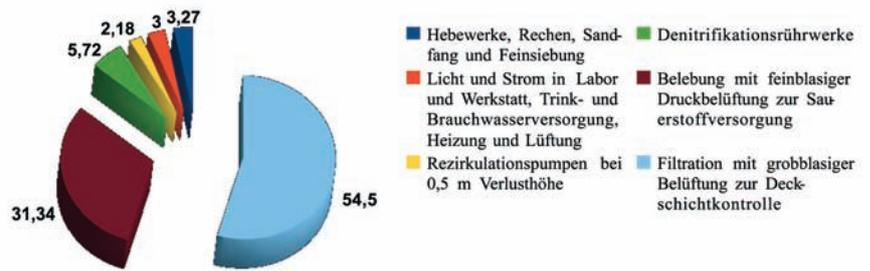
Abb. 1: Prozentuale Verteilung des Energieverbrauchs auf Membrankläranlagen in Labor und Werkstatt
