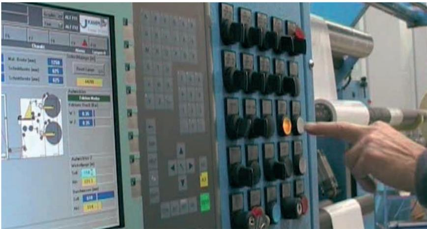
Abb. 1: Schneid- und Wickelmaschine mit Maschinenbedienfeld und Visualisierung
