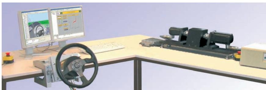
Abb. 5: HiL-Prüfstand mit Fahrzeugmodell und Torque-Feedback-Lenkrad
