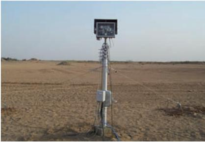
Abb. 1: Kameraplattform (teleskopisch) für die Erfassung der Wasserversorgung und Bioaktivität
