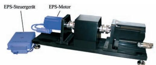
Abb. 2: Aufbau des HiL Prüfstands
