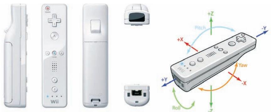
Abb. 1: Der Wiimote Controller von Nintendo. Das Gerät zeichnet beschleunigungs-basierte Daten in x, y, z Richtung auf. Die Daten werden drahtlos per Bluetooth übertragen und können mit herkömmlichen PC-Systemen ausgelesen werden.
