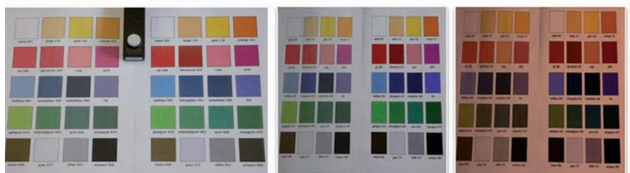
Abb. 6: Farbtechnische Betrachtung mit unterschiedlichen Farbtemperaturen (von links nach rechts): Referenzmessung bei Tageslicht 850 Lux, 4000°K 100 Lux, 2000°K 100 Lux
