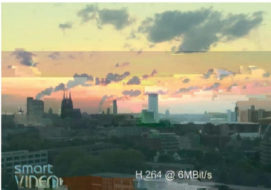
Abb. 2: H.264 Full HD bei 1 % Prozent Paketverlust
