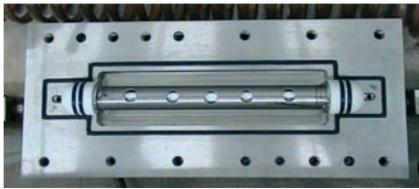
Abb. 4: Ansicht Testzelle mit Membranrohr
