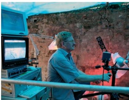
Abb. 2: Prof. Dr. Fuchs bei Untersuchungen mit UV/VIS/IR Bandpassfilter Videoerfassungssystem
