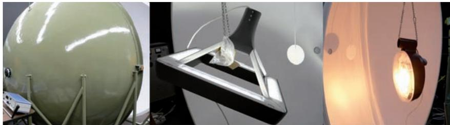
Abb. 7: Messung mit der Ulbrichtkugel des Institutes für angewandte Optik und Elektronik
