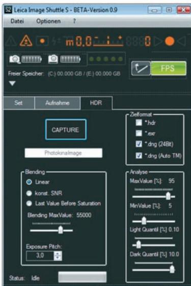
Abb. 5: Graphisches User-Interface zur Steuerung der HDR-Funktionalität. Der gesamte Ablauf wird durch einen einzigen Click auf den Capture-Button ausgelöst.
