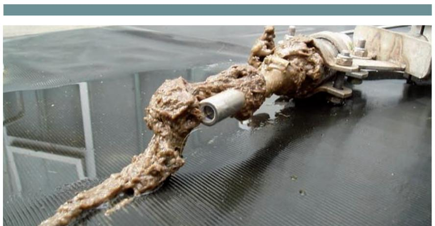
Abb. 12: Verschmutzung der Messsonde
