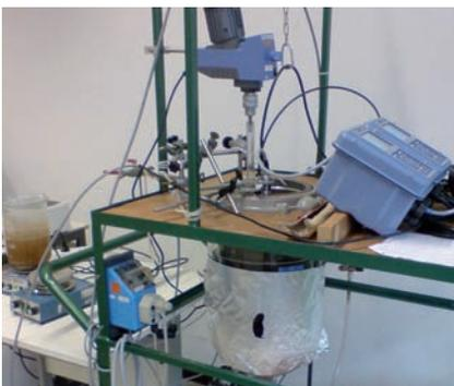
Abb. 7: Deni-G [6] Reaktoren zur Kultivierung der denitrifizierenden Bakterien
