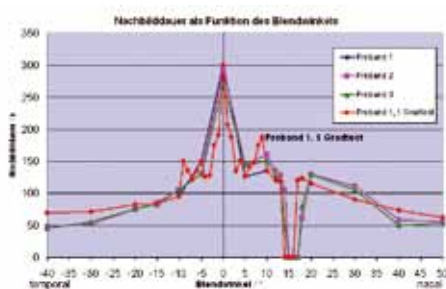
Abb. 1: Nachbilddauer als Funktion des Blendwinkels für Proband 1, 2 und 3 ( t_{exp} = 10 s; bei P = 30 \mu\text{W} ), („temporal“ steht für „schlafenwärts“ und „nasal“ für „zur Nase hin“)
