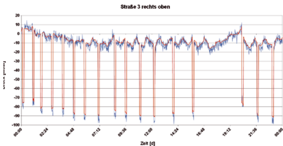
Abb. 3: Vergleich gemessener zu simuliertem Druck Straße 3, rechts oben für die Daten vom 22.05.2009
