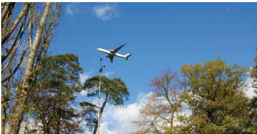
Abb. 1: aufgestelltes Messsystem zur Langzeitlärmmessung in der Nähe eines Flughafens. Die Zeiträume, in denen ein Flugzeug in diesen Aufzeichnungen zu erkennen ist, werden dokumentiert.
