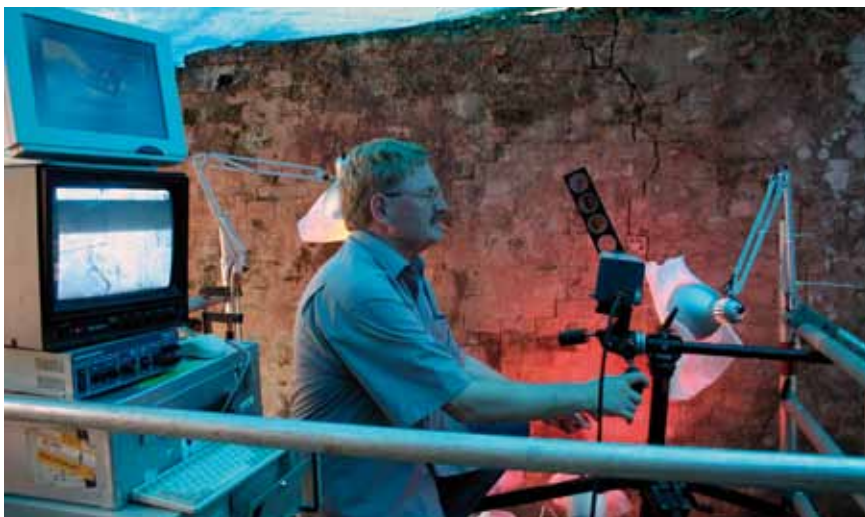
Abb 1: Untersuchung der bemalten Wände des Tempels von Koh Ker, Kambodscha mit der Bandpassfilter-IR-Reflektographie
