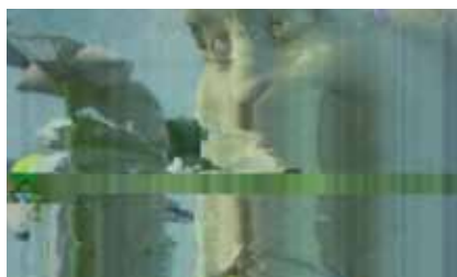
Abb. 6: Störung eines MPEG4 Streams durch Paketfragmentierung
