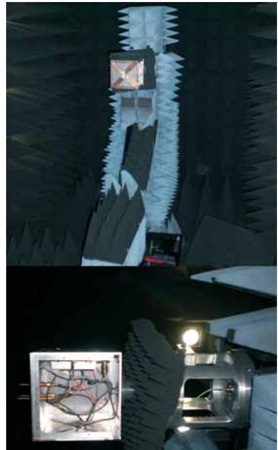
Abb. 2: MIMO-Antennen-Referenz-System (MIMO-Würfel)
