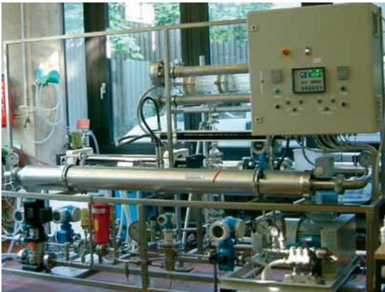
Abb. 7: Technikumsanlage zur Bestimmung der Trenncharakteristik
