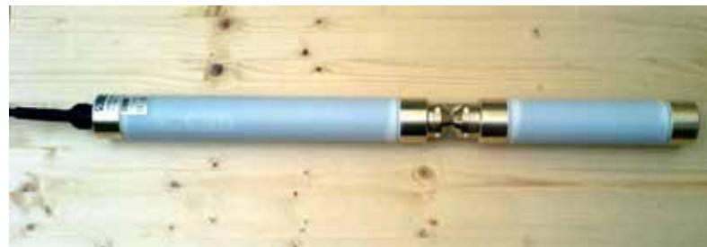
Abb. 3: Eingesetzte UV/Vis-Sonde der Firma S::CAN
