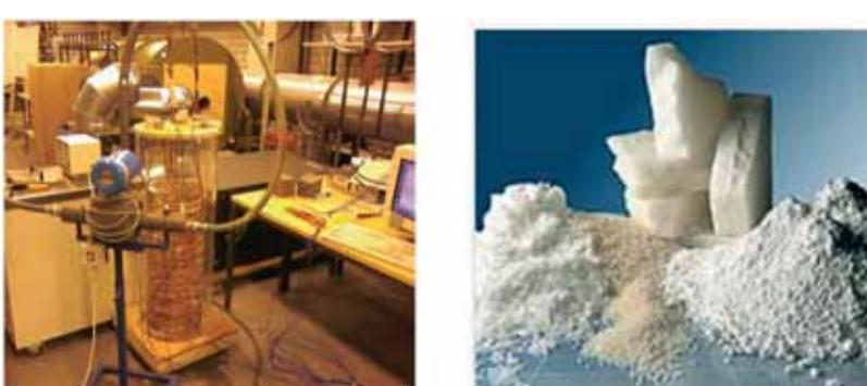
Abb. 6: Paraffine der Firma RUBITHERM, untersucht im DSC zur weiteren Verwendung im PCM-Latentwärmespeicher
