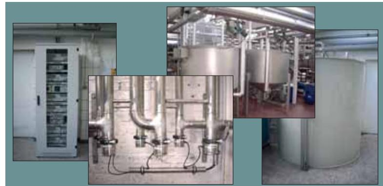
Abb. 4: Organo-Phosphat-Reduktion bei einem Gardinenhersteller durch Ultraschall in einer Pilotanlage mit sechs Meinhardt US K8 Transducern
