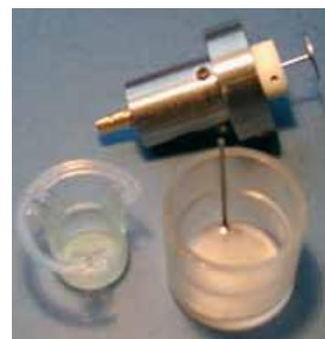
Bild 6: Probengefäß eingebettet in den HF-Parallelplattenleiter und NF-Elektroden
