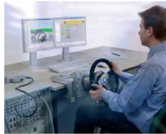
Bild 1: Hil-Prüfstand mit Torque-Feedback-Lenkrad
