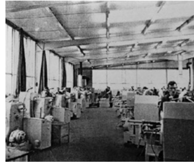
Pirex-Futterautomaten zu Bearbeitung von Formteilen
