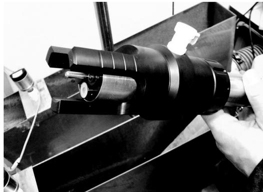
Abbildung 5: Sensorkopf mit aufgesetzter Luftspülung
