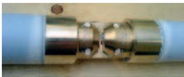
Abbildung 6: Messspalt eines Spectrolyzers
