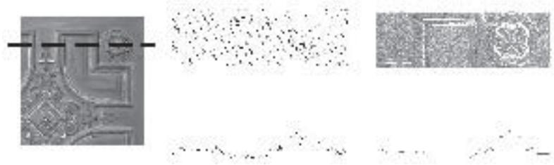
Abb. 9: Ausschnitt der Stuckdecke: Orthophoto mit Eintragung der Schnittlinie, Ansicht und Schnitt der Punktwolke des Laserscanners, Ansicht und Schnitt entwickelt aus der Aufnahme des Streifenlichtscanners
