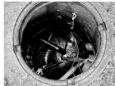
Abbildung 4: Messproben-Entnahme mit Schneidpumpwerk im Kanal
