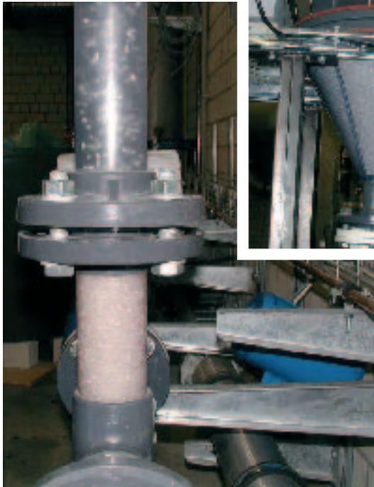
**Bild 1/2:** Teile des experimentellen Aufbaus der Testanlage mit T-Stück zur Einrieselung und Schüttgutbehälter aus transparentem PVC
