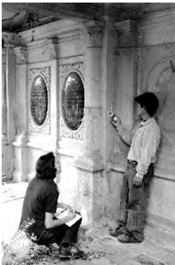
Abb. 5: Messung der Wasseraufnahme des Sankt Margreter Molasse-sandsteins durch die Studentin Manuela Freund und den kambodschanischen Restaurator Mr Long Nary während seines Trainingsaufenthaltes in Deutschland
