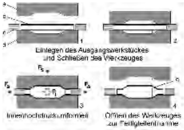
Bild 1: Verfahrensprinzip (a Oberwerkzeug, b Ausgangswerkstück, c Axialstempel, d Unterwerkzeug, e Fertigteil)
