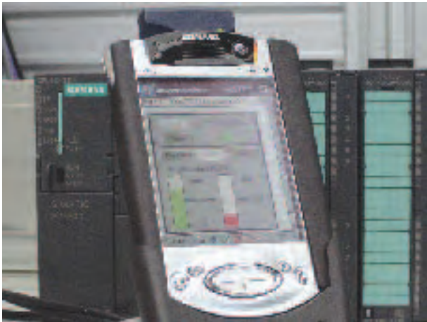
Bild 7: Mobiles Endgerät mit Web-Interface zur Anlagenüberwachung
