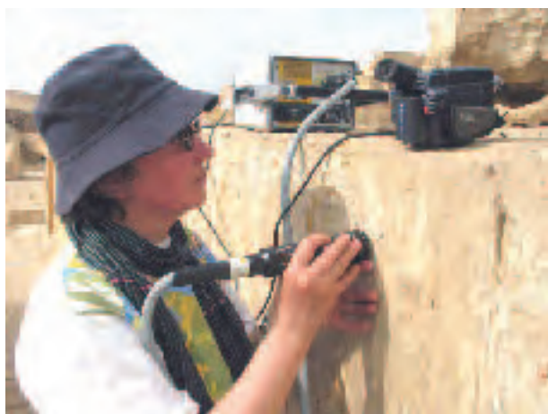
Abb. 4a, b: Untersuchungen von Farbfassung und Putzaufbau mit dem Videomikroskop und zur kapillaren Wasseraufnahme mit dem Karsten'schen Prüfröhrchen
