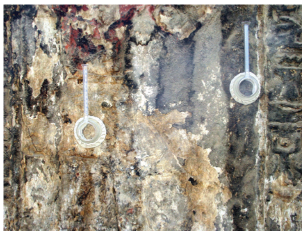
Abb. 4a, b: Untersuchungen von Farbfassung und Putzaufbau mit dem Videomikroskop und zur kapillaren Wasseraufnahme mit dem Karsten'schen Prüfröhrchen
