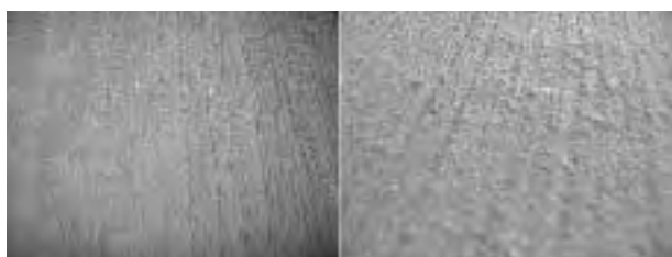
Abbildung 2: Oberfläche einer Probeplatte im Anfangszustand (links) und nach 90.000 Überrollungen (rechts)
