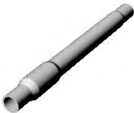
Bild 2: CAD-Entwurf eines hohlwellenförmigen Mikrobauteiles
