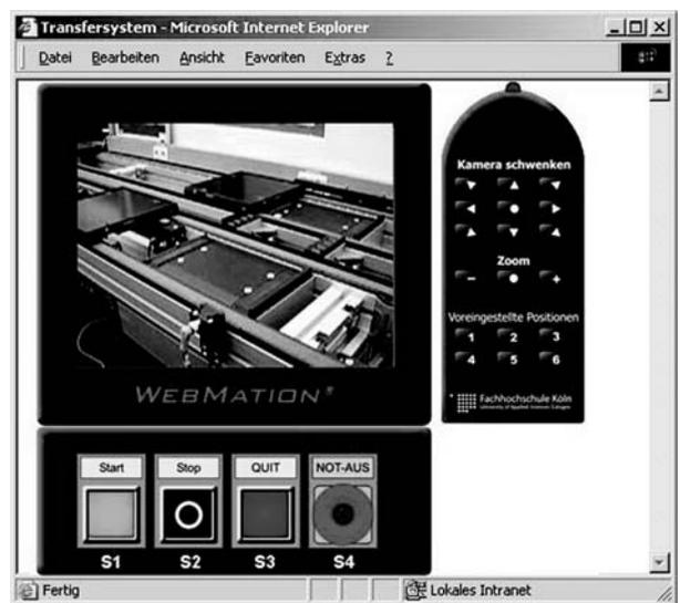
Bild 3: Beobachtung des Transfersystems mit der fernbedienbaren Web-Kamera
