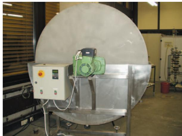
Abb. 2: Modellreaktor zu Untersuchung der Filmbildung bei der Synthese von PET
