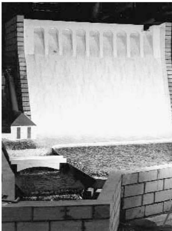
Bild 2: Modell der Aggertalsperre bei einem extremen Hochwasserereignis
