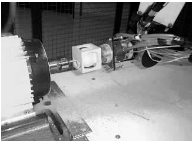
Bild 3: Fräsen der Kugel mit dem Roboter
