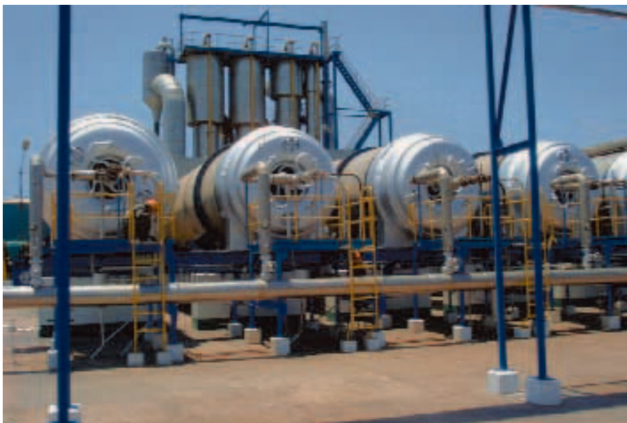
Bild 6: Trommeltrockner der Fischmehlfabrik Epesca in Pisco – Peru; die Optimierung des Anlagenbetriebs mit Neuronalen Netzen ist in Bearbeitung.
