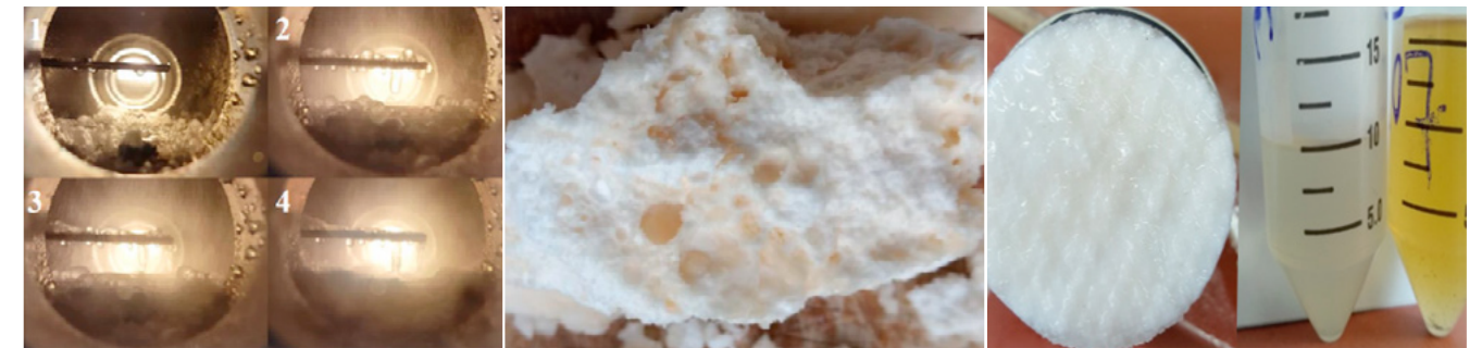
Gashydrat-Bildung in einem Sprühreaktor in vier Schritten, aufgenommen durch ein Beobachtungsfenster am Boden des Druckbehälters. In der jeweiligen Bildmitte befindet sich ein Temperaturfühler.
