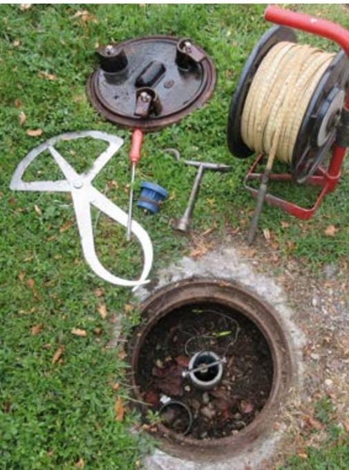
Arbeitsmittel für die Bestandsaufnahme von Grundwassermessstellen im Gelände
