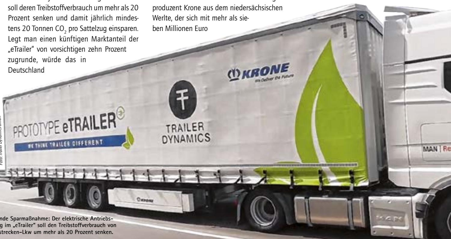
Rollende Sparmaßnahme: Der elektrische Antriebsstrang im „eTrailer“ soll den Treibstoffverbrauch von Langstrecken-Lkw um mehr als 20 Prozent senken.
