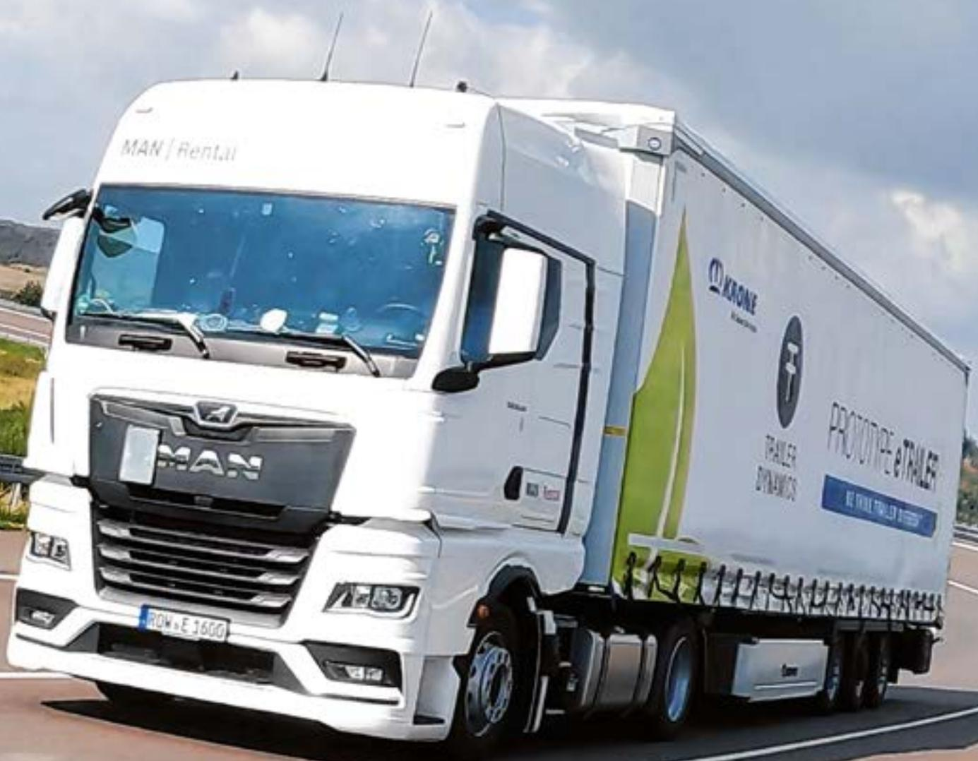
Schwergewicht mit Leichtigkeit: Im Prototypen-Anhänger von Trailer Dynamics sorgt ein elektrischer Antrieb für eine deutliche Emissionsreduktion des gesamten Sattelzugs.
