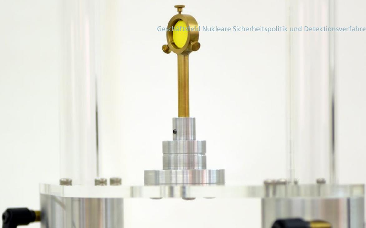
Quellenhalter des dynamischen Qualifizierungs-Testsystems für Strahlungsmessgeräte
