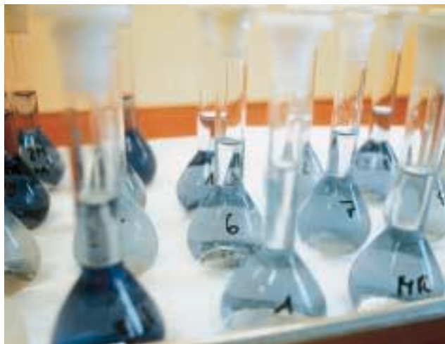
Abb. 6: Wasserproben einer Analysenserie, die durch entsprechende Vorbehandlung je nach Phosphatgehalt eine mehr oder minder starke Blaufärbung aufweisen.
