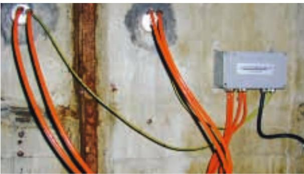
Überwachung der Kontaktfuge zwischen Abstützbalken und Pfeilerkragarm mit zwei Zweifachstangenextensometer mit Fernübertragung
