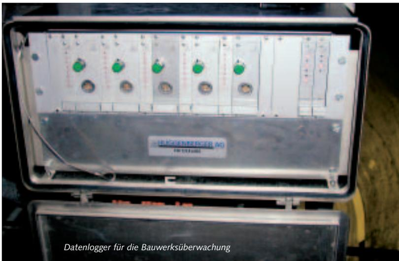
Datenlogger für die Bauwerksüberwachung
