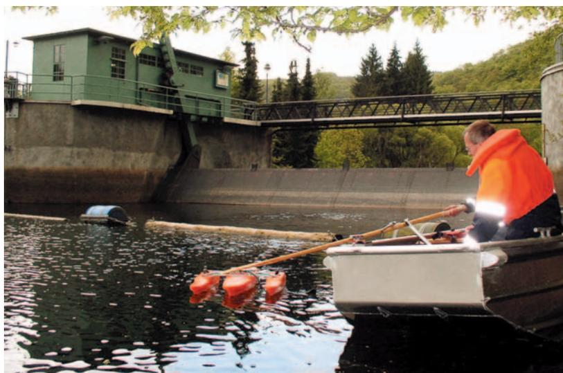
*Testmessungen mit dem neuen ADCP-Messgerät am Staubecken Heimbach*
