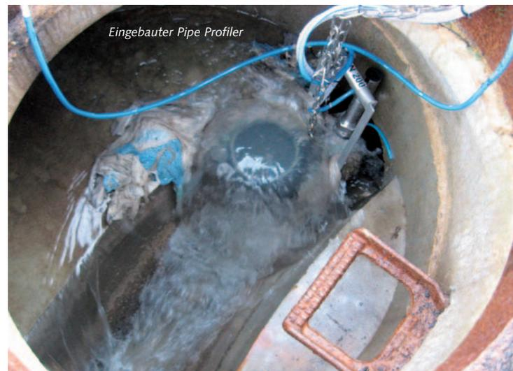
*Eingebauter Pipe Profiler*
