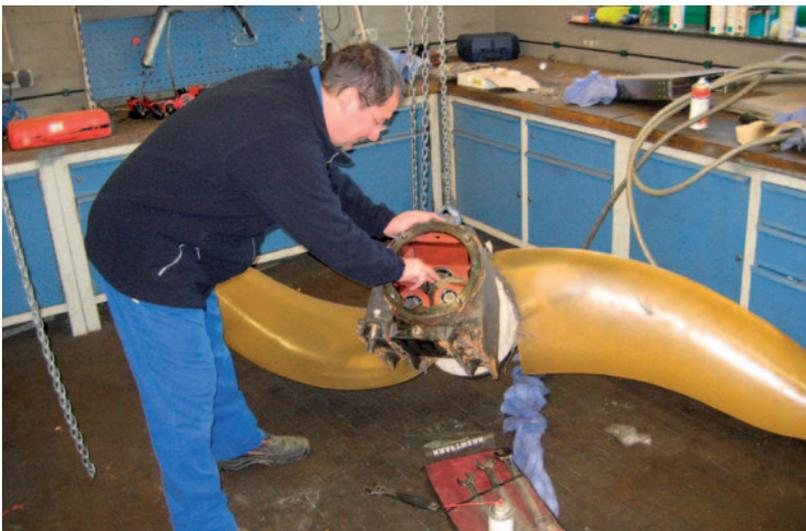
*Verschlissener Maschinenkolben auf der KA Eschweiler*
