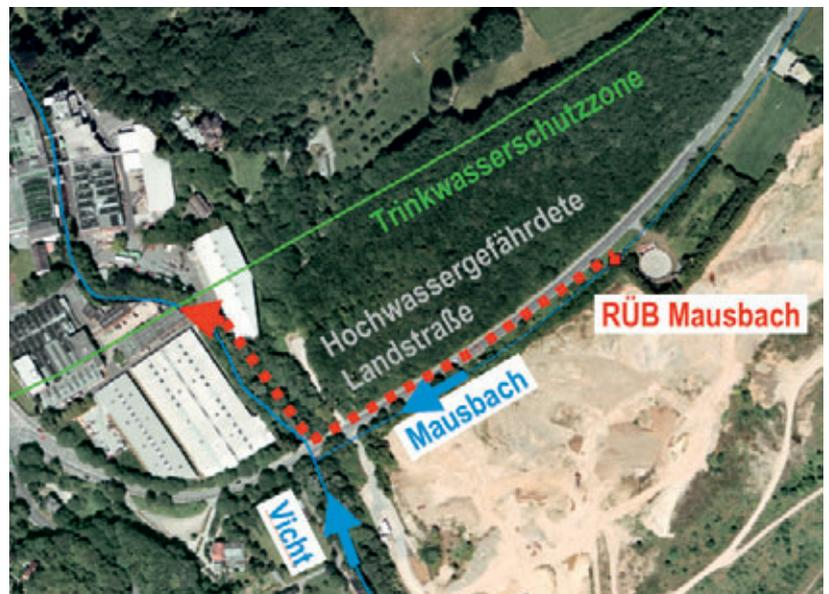
Zunächst wurde mit einem hydrologischen Modell des Kanalnetzes Mausbach überprüft, welches RRB-Volumen erforderlich wäre, um den Forderungen nach Trinkwasser-, Erosions- und Hochwasserschutz nachkommen zu können. Da der Mausbach ein sehr kleines und leistungsschwaches Gewässer ist, wäre ein RRB-Volumen von
