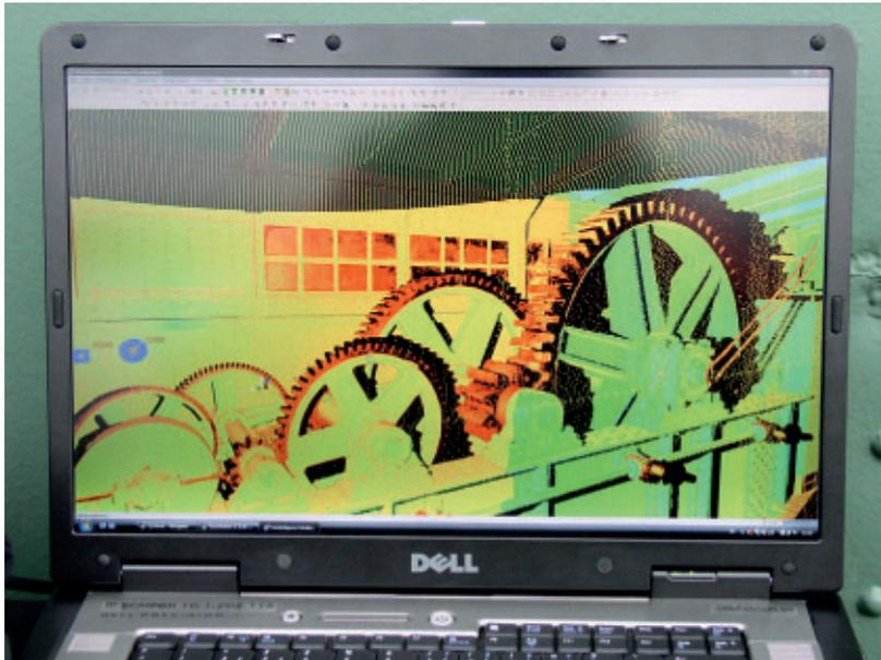
Im April 2009 fand ein weiterer Vermessungstermin mit dem Laserscanner statt, hierbei wurde die Klappe von 213,50 m auf 213 m abgesenkt. Die Auswertung im Mai ergab, dass das Windwerk einwandfrei läuft. Die terrestrische Laserscanaufnahme kann jederzeit wiederholt und mit der vorhandenen Messung durch eine Überlagerung verglichen werden. Geometrische Eigenschaften von sog. Punktwolken fester Geometrien und geodätische Festpunkte, die durch das
