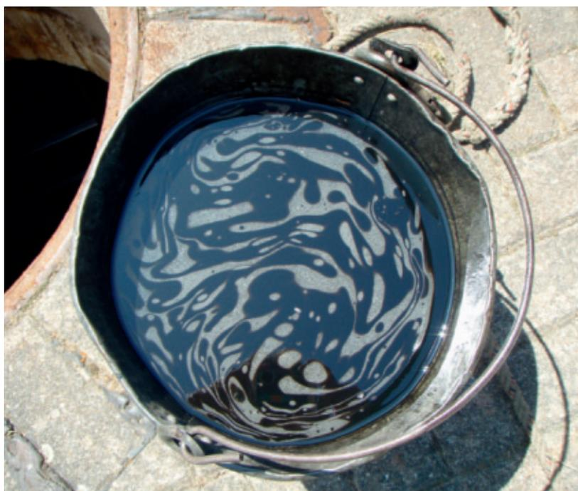
*Eine aus dem RÜB Merkstein entnommene Probe mit einem Eimer zeigt deutlich das oben aufschwimmende Öl*
