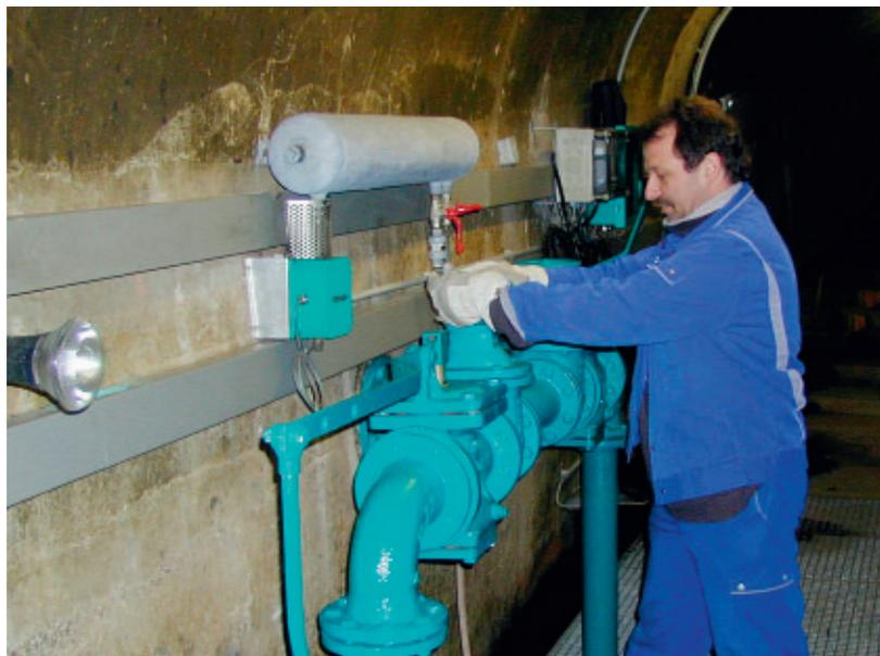
Wolfgang Hoernchen bei der Durchführung einer Sickerwasserüberwachungsmessung an der Oleftalsperre
