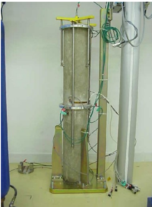
Abb. 4.5 Bilder der Messaufbauten des Schwindversuchs (links) und des Kriechversuchs (rechts) (Foto von EDF bereitgestellt)
