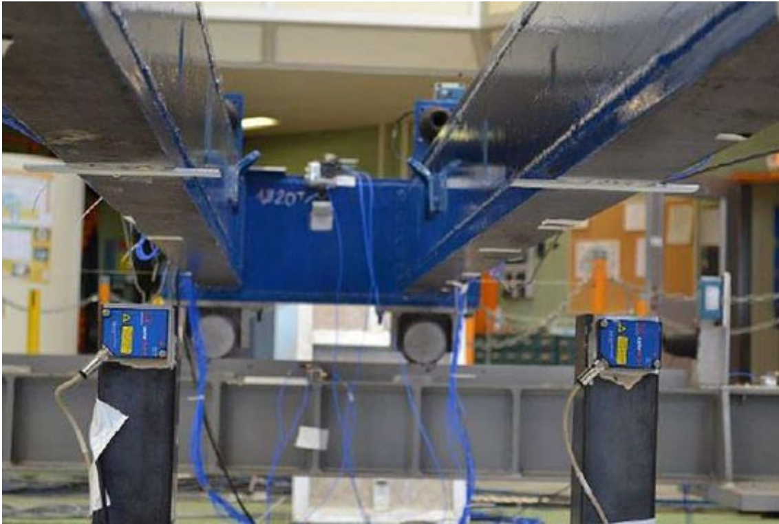
Abb. C.11 Zwei Laser-Triangulationssensoren mit der Bezeichnung DzPcharge1 und DzPcharge2 messen die z-Verschiebung der Brückenträger
