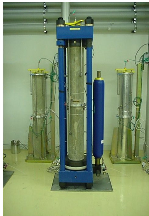
Abb. 4.5 Bilder der Messaufbauten des Schwindversuchs (links) und des Kriechversuchs (rechts) (Foto von EDF bereitgestellt)
