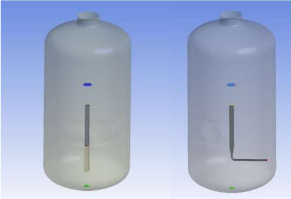
**Abb. 4.1** Geometrie beim H2P1\_TE-Experiment bei Annahme eines geraden (links) und eines gekrümmten Einlassrohres (rechts)
