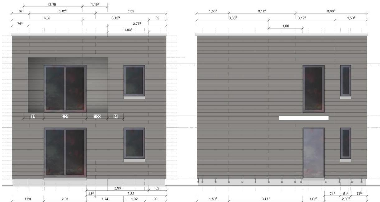
Bild 64 Variante 4: Fassadensystem aus Stegträgern, Mineralwolle und Eternit- Ansichten (Links: Ostseite. Rechts Nordseite)
