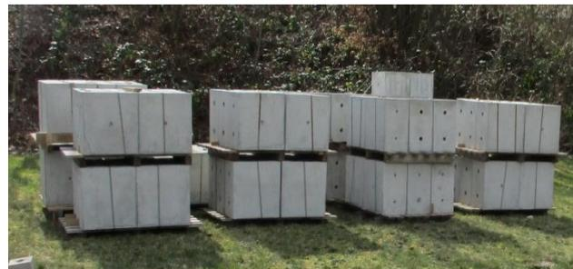
Bild 116 *Hergestellte Fundamentsteine*
