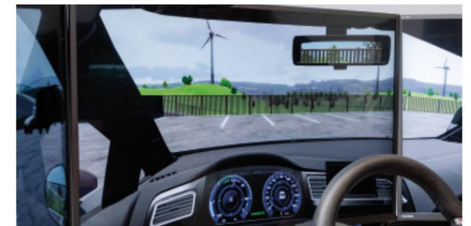
Nach Einzelübungen, wie z. B. Anfahren, Kurvenfahrten und Abbiegen können auch komplette Fahrten mit dem Simulator ausgeführt werden. Durch ein intelligentes Überwachungssystem werden alle Aktivitäten bei der Fahrt protokolliert. Richtiges Blinken und Schalten werden ebenso abgefragt, wie der zwingend erforderliche Schulterblick, der durch eine Kamera überwacht wird. Durch das komplexe Computersystem mit Rückfahrmonitor kann selbst rückwärts einparken geübt werden.
