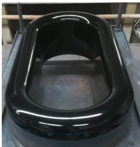
Abb. 13: Klüse für Superyacht – rein induktiv
