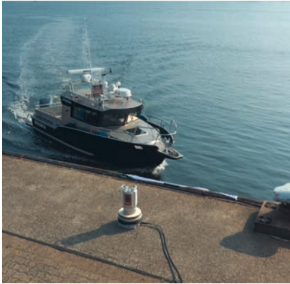
Abb. 5: Der mobil einsetzbare Laserscanner unterstützt bei Hafenmanövern, hier in Wilhelmshaven.
