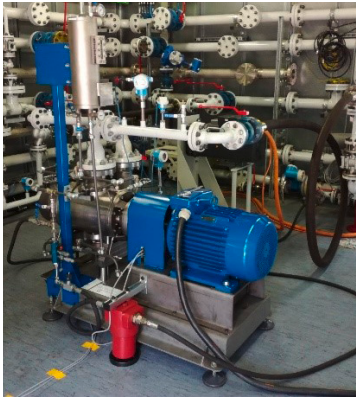
Abb. 5: Versuchsaufbau des zweiflutigen CGC-Demonstrators bei der Erprobung
