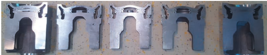
Abb.13: visionärer Leichtbaukolben mit einem Durchmesser 160 mm
