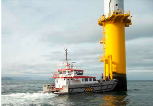
Abb. 10: Crew Transfer Vessel (CTV) unter Standschubbedingungen.
