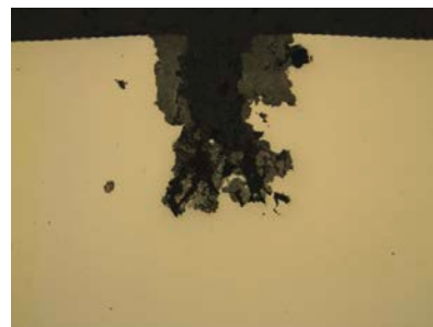
Abb. 17: Metastabile Lochkorrosion ohne Rissbildung (100:1)
