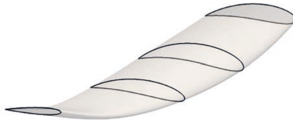
Abb. 2: Darstellung des Aufbaus des HiOfoils mit Profilschnitten
