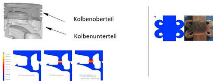
Abb. 8: Reibschweißvorgang, oben links: Übersicht, oben rechts: Evaluierung der vorhergesagten Reibschweißnaht (Wulstausbildung), unten: ausgewählte Phasen des Reibschweißprozesses
