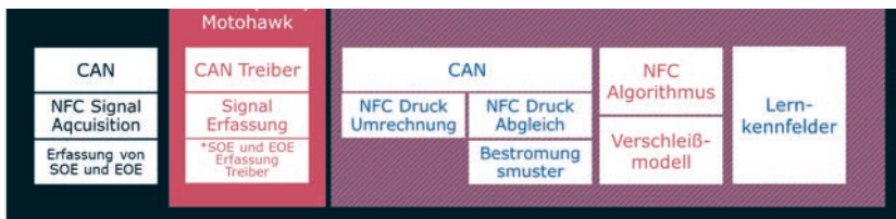
Abb. 6: Injection Control Unit (ICU) als Hardwareübersicht
