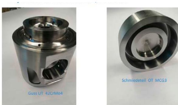
Abb. 5: Reibgeschweißter Großkolben, links Unterteil= Gusswerkstoff, Mitte Oberteil = Vergütungsstahl
