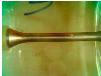
Abb. 19: Wasserstoffblasen an SSRT-Probe
