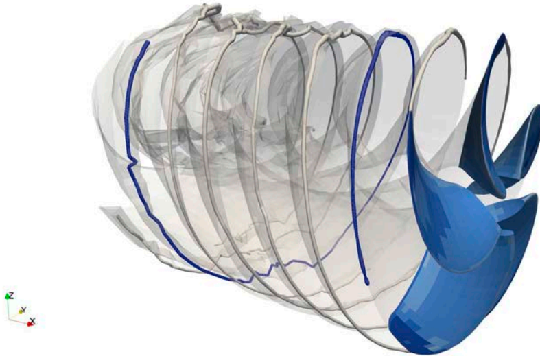
Abb. 7: Mit panMARE in Kopplung mit dem Spitzenwirbelmodell panACav numerisch berechneter Spitzenwirbel
