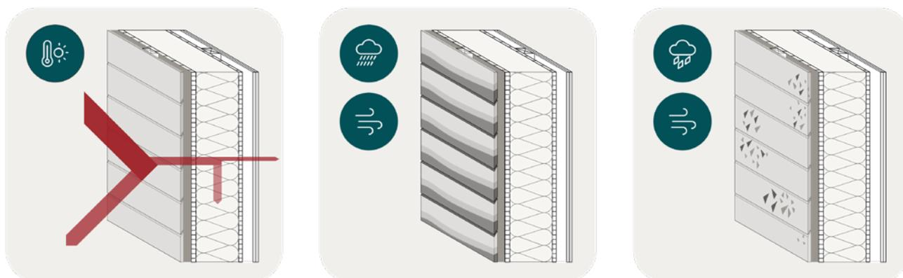
Abb. 54 Auswirkungen der Wetterelemente auf die hinterlüftete Holzleichtbaukonstruktion. Links: Hitzeintrag in das Bauteil. Mitte: Feuchteintrag infolge Schlagregen. Rechts: Schäden an der Holzoberfläche infolge Hagel und Sturm.
