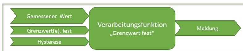
**Bild 40:** Funktionsschema einer GA-Verarbeitungsfunktion aus dem Abschnitt „Überwachen“ von DIN EN ISO 16484-3 - hier als Beispiel die Funktion „Grenzwert fest“
