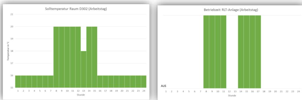
**Bild 48:** Ansichten aus der Benutzeroberfläche eines Zeitschaltprogramms für analoge Größen (links) bzw. für binäre Größen (rechts)
