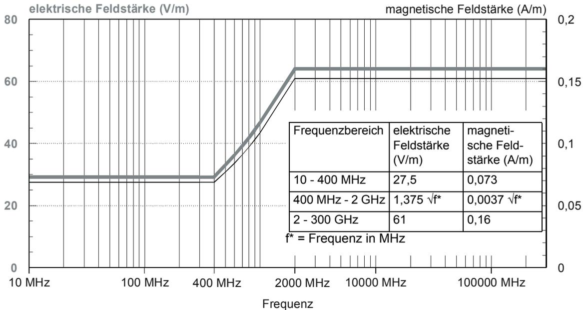
**Abbildung 1.3-1 Grenzwerte der 26. BImSchV für feststehende Hochfrequenzanlagen**
