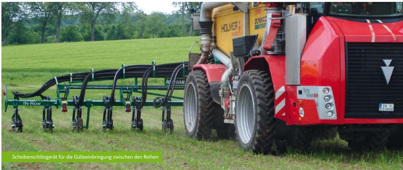
Scheibenschlitzgerät für die Güllebringung zwischen den Reihen
