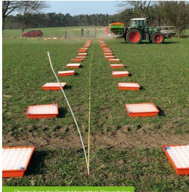
Überprüfung des Streubildes mittels Streuschalen
