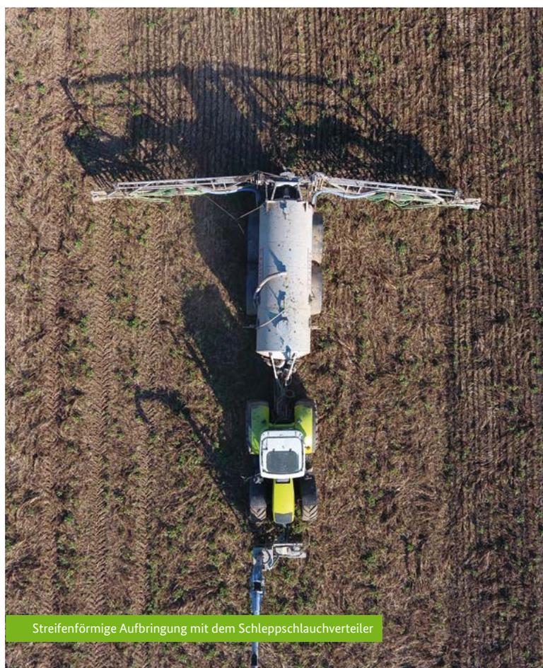
Streifenförmige Aufbringung mit dem Schleppschlauchverteiler
