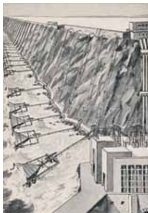
Ein amerikanischer Entwurf eines Wellenkraftwerks nach dem Prinzip des hydraulischen Widders
