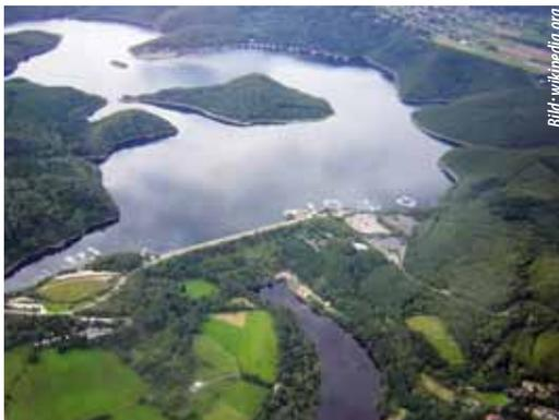
die Bevölkerung, Brauchwasser für die Industrie und der Energiegewinnung. Das Stauvolumen der Rurtalsperre Schwammenauel und des Obersees beträgt 203,2 Millionen m<sup>3</sup>.
