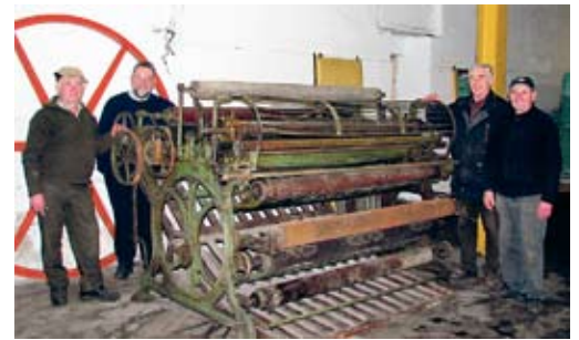
Fertig zusammengebaute Schermaschine
