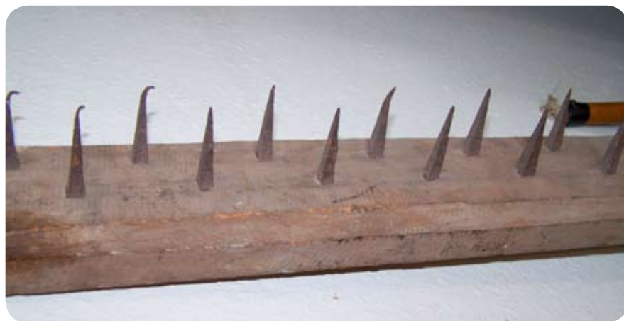
Das Nagelbrett wurde vom Zoll eingesetzt, um Fahrzeuge zu stoppen.
