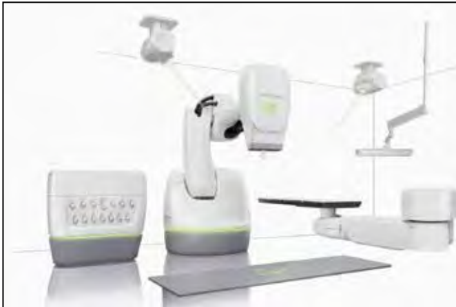
Abb. 1. CyberKnife System. Das Bestrahlungsgerät hängt an einem Roboterarm und wird dadurch extrem genau gesteuert. Durch Röntgenröhren an der Decke und Infrarotsensoren werden die Lagerung des Patienten und Bewegungen während der Behandlung kontinuierlich überwacht, und ggf. kann der Roboter die Bestrahlung sofort korrigieren, © Accuray Inc, USA (mit Genehmigung der Verwendung)
