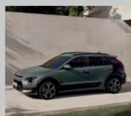
Mit 4,42 Metern ist der neue Kia Niro um 65 mm länger als sein Vorgänger – der Radstand misst 2,72 Meter. Der 1,6-Liter-Vierzylinderbenzinmotor des Niro Hybrid mobilisiert 105 PS (77,2 kW). Zusammen mit dem Elektromotor, einer 32 kW starken Permanentmagnet-Synchronmaschine, leistet das Antriebssystem 141
