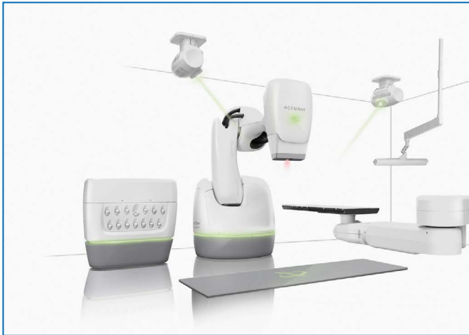
Abb. 2. CyberKnife System: Das Bestrahlungsgerät hängt an einem Roboterarm und wird dadurch extrem genau gesteuert. Durch Röntgenröhren an der Decke und Infrarotsensoren werden die Lagerung des Patienten und Bewegungen während der Behandlung kontinuierlich überwacht. Wenn nötig, kann der Roboter die Bestrahlung sofort korrigieren.
