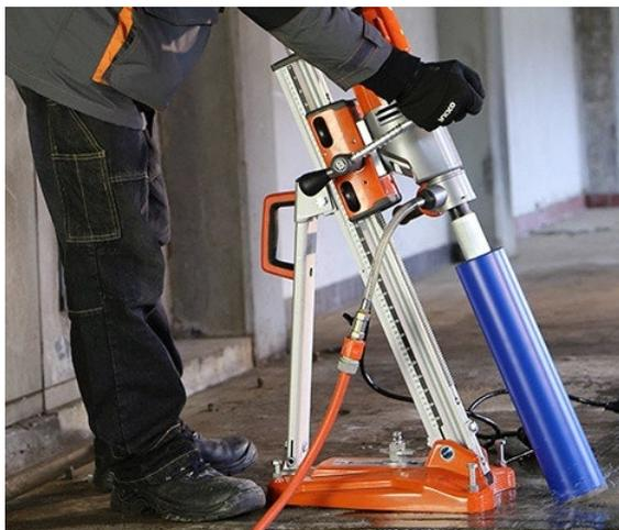
Abbildung 10: Diamant-Kernbohrgerät auf Deckenplatte [BOE2020]
