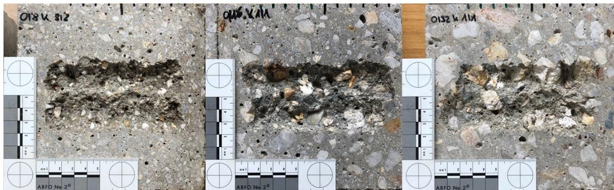
Abbildung 42: Ergebnisse der Spurversuche in Beton (Links 0 – 8 mm, Mitte 0 – 16 mm, Rechts 0 – 32 mm)
