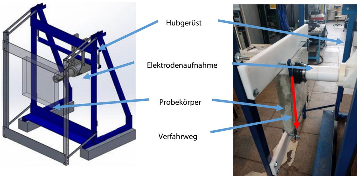
Abbildung 46: Versuchsstand kontinuierliche Versuche vertikal
