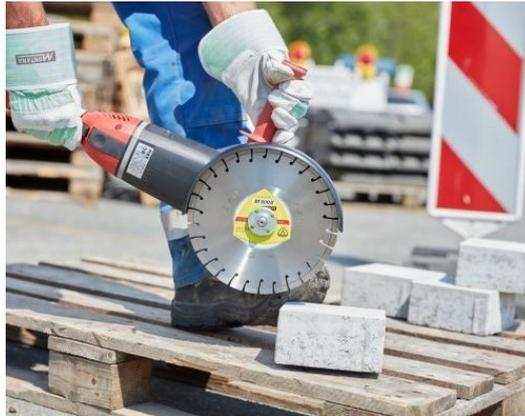
Abbildung 8: Winkelschleifer mit Diamanttrennscheibe [TAS2020]
