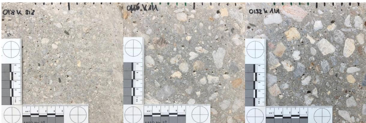
Abbildung 40: Schnittfläche der Betonproben (Links 0 – 8 mm, Mitte 0 – 16 mm, Rechts 0 -32 mm)
