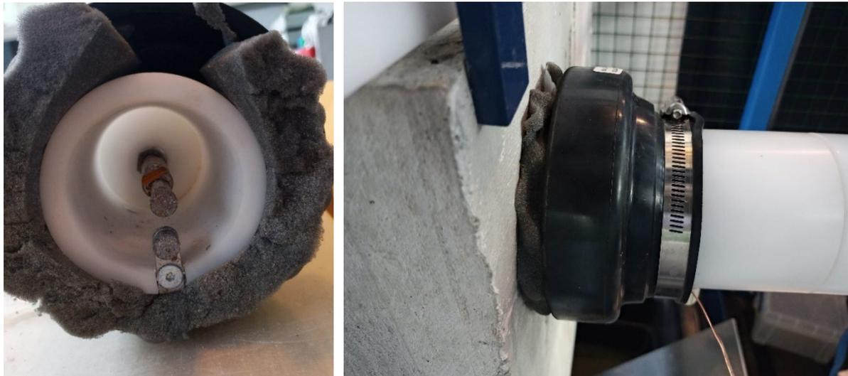
Abbildung 47: Elektrodenaufnahme mit flexibler Prozessraumabdichtung
