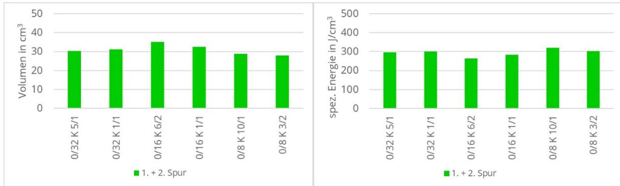
Abbildung 43: Gelöstes Volumen (li.) und spezifische Energie (re.) der Spurversuche in Beton
