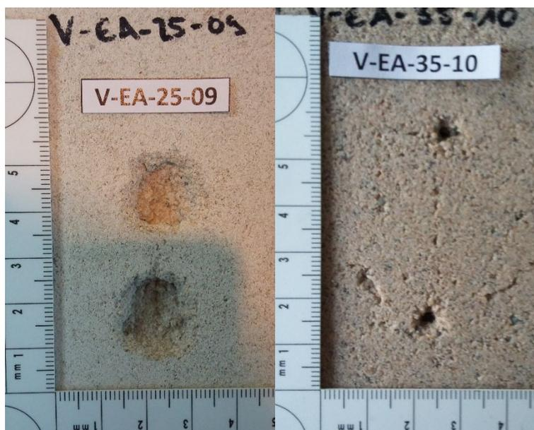
Abbildung 16: Punktuelle Ausbrüche (li.) und Ausbildung des Durchschlagkanals (re.)
