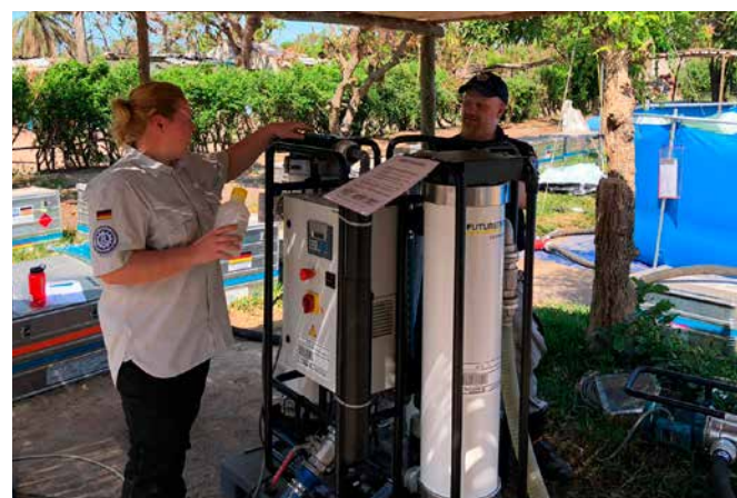
Bis die Brunnen zur Versorgung der Menschen repariert waren, setzte das THW die Trinkwasseraufbereitungsanlage „WTC 5000“ ein. Diese produziert stündlich bis zu 5.000 Liter Trinkwasser nach WHO-Standard. | Before the wells were repaired and fit to supply the population, the THW set up the drinking water treatment unit WTC 5,000, which can produce up to 5000 litres of drinking water per hour satisfying WHO standards.
