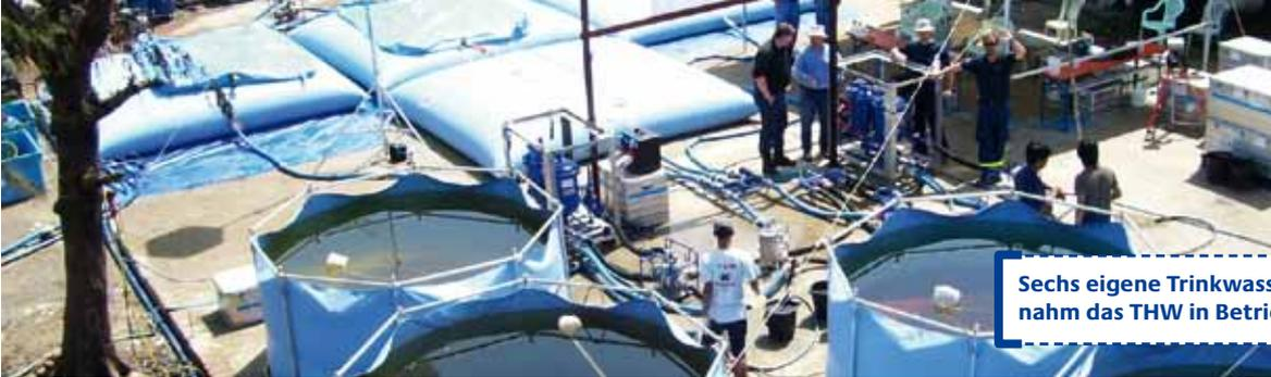
Sechs eigene Trinkwasseraufbereitungsanlagen nahm das THW in Betrieb.
