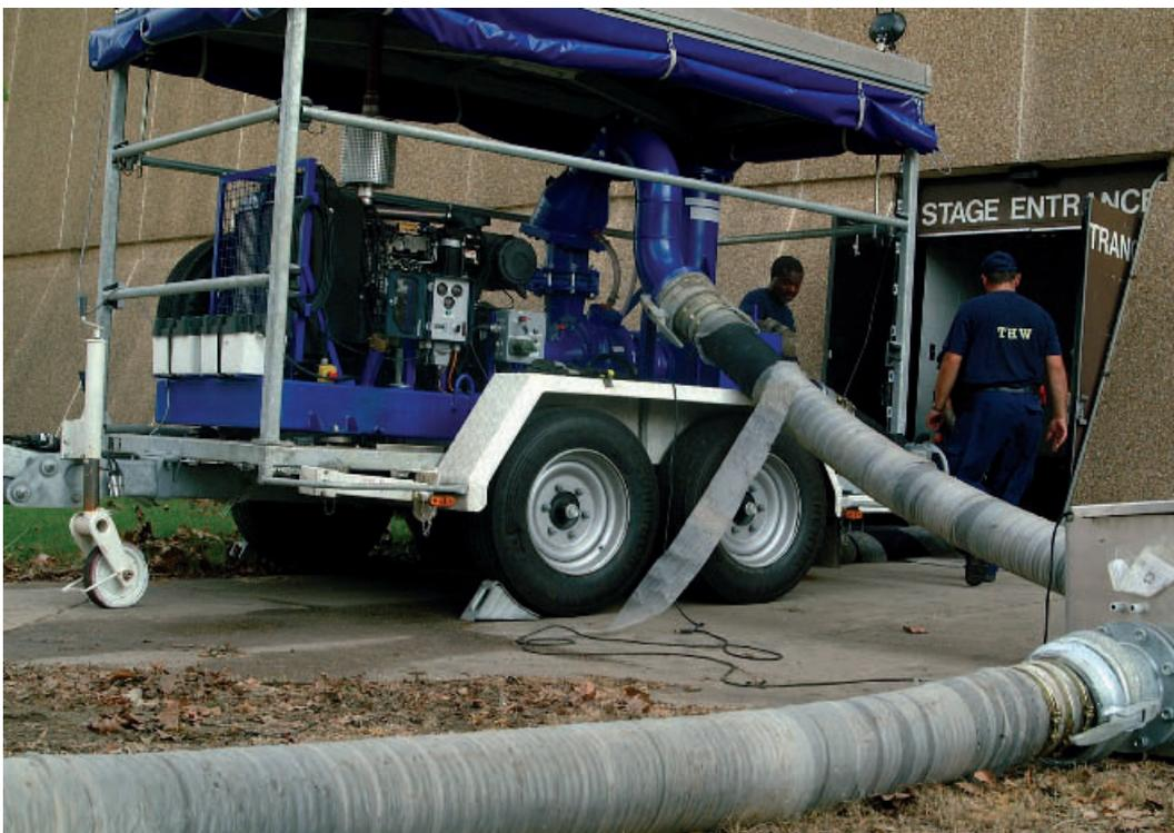
**Effektives Instrument beim Bekämpfen von Wassermassen: die Hochleistungspumpen des THW**
