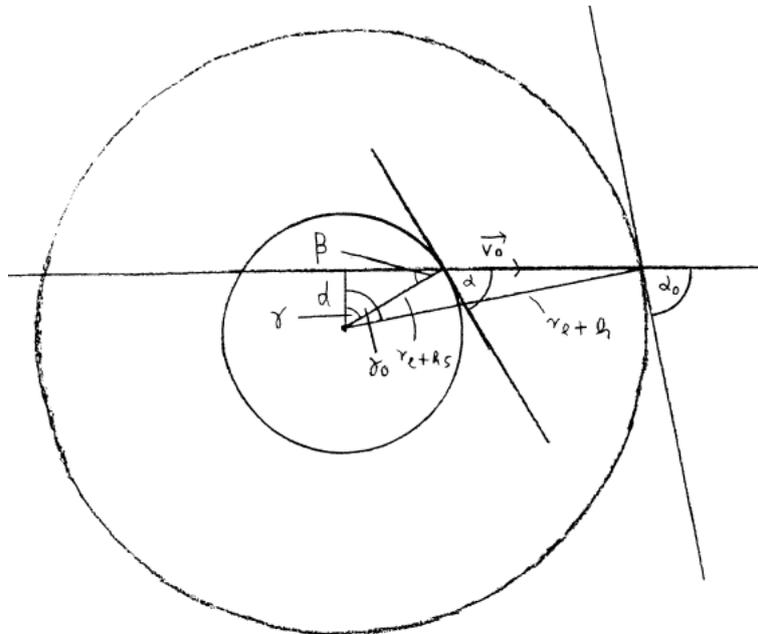
Die Tangente weist in Richtung von  $\vec{v}_r$ .  $\vec{v}_0$  zeigt in die Richtung der Senkrechten zu  $d$ . Es gilt  $\gamma + \beta = 90^\circ$  und  $\beta + 90^\circ + \alpha = 180^\circ$ . Daraus erhalten wir:
