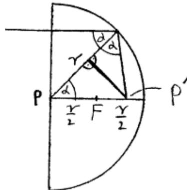
Kegelschnittspiegel gelten, sofern  $G, B \ll a, b, r$  ist. Diese Abbildungsgleichungen gelten also bei Kugelspiegeln, Parabolspiegeln und Spiegeln mit der Form von Rotationsellipsoiden bzw. Rotationshyperboloiden.
