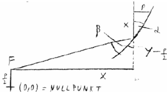
Wir zeigen, daß sich achsenparallele Strahlen nach der Reflektion im Brennpunkt  $F$  schneiden.  $\beta$  ist nach dem Reflektionsgesetz gleich  $\alpha$ . Also kommen wir auf folgende Gleichung:
