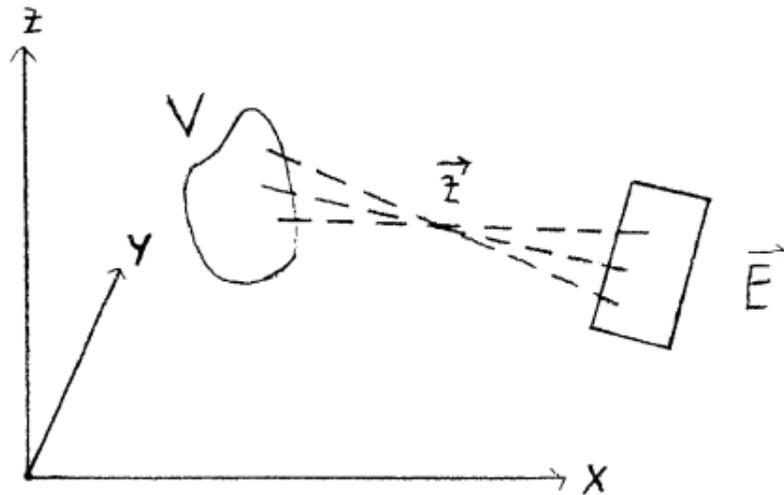
Eine Menge  $V \subset \mathbb{R}^3$  wird durch eine Zentralprojektion mit dem Punkt  $\vec{z}$  auf eine Ebene  $\vec{E}$  abgebildet. Es geht um die Darstellung der Abbildung auf der Ebene  $\vec{E}$ .  $\vec{E}$  stellt eine „Mattscheibe“ hinter  $\vec{z}$  dar. Diese Situation kann näherungsweise mit der Abbildung der Augenlinse verglichen werden, wenn der Abstand zwischen  $V$  und  $\vec{z}$  sehr groß gegenüber dem Abstand von  $\vec{z}$  und  $\vec{E}$  ist.
