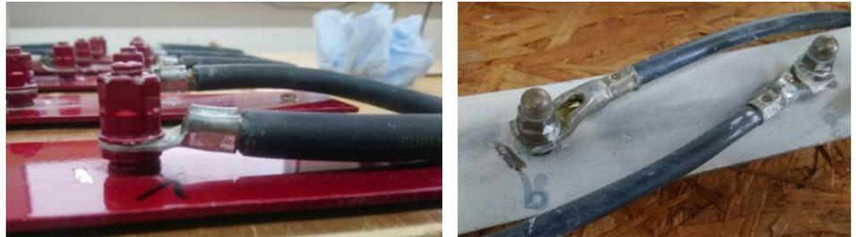
Die Systemgrenzen der Funktionsbaugruppe Schraubkontakte ist in der nächsten Abbildung zu sehen. Alle Bereiche außerhalb der gestrichelten Linie werden nicht berücksichtigt. Diese beschränkt sich auf die Schweißverbindung zum Blech, die Schraubverbindung Bolzen-Mutter-Kabelschuh und die Verbindung zur Leitung ggf. ihrer Abdichtung. Alle Bereiche außerhalb der gestrichelten Linie werden nicht berücksichtigt.
