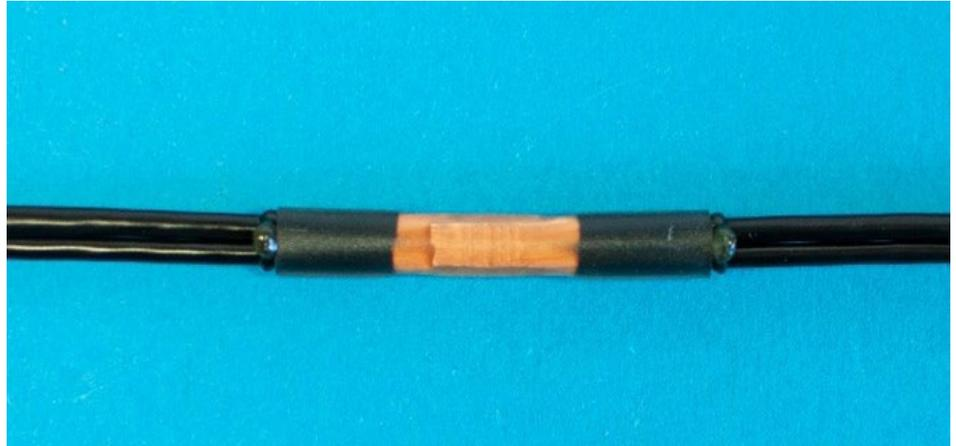
Ein Kleberaustritt an den Schlauchenden ist kein Qualitätskriterium der Dichtigkeit (Beachtung der Verarbeitungsanleitung der Schrumpfschlauchhersteller). Bei der Positionierung der Schlauchabschnitte muss die Verarbeitungsanleitung der Schrumpfschlauchhersteller berücksichtigt werden. Die Länge L des Schrumpfschlauches mit Kleber ergibt sich aus der Länge C der Schweißstelle + 2 x A (3-5mm) + 2 x D (Minimumüberlappung auf der Kabelisolierung von > 10 mm je Seite).
