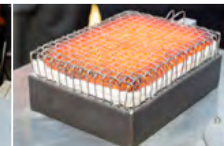
Das Herzstück der Innovation: Ein Porenbrenner, der sich als besonders energieeffizient, schadstoffarm und robust erwiesen hat.
