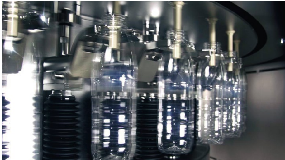
Trockensterilisation mit Wasserstoffperoxid
